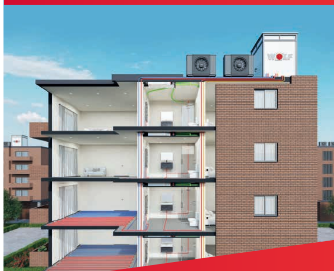
Sistema de uso colectivo en edificación multifamiliar
